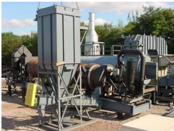
Figura 6.6.6.1-1: Equipamento de dessorção térmica. Fonte: Tarmac.
